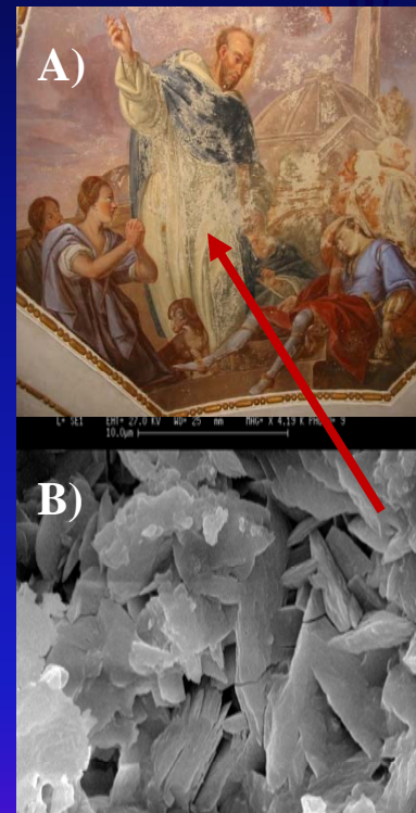
A) Chiesa di San Francesco, Gela: fiori d'intonaco; B) SEM dei cristalli di gesso.
