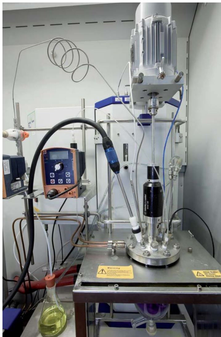
Calorimetro di reazione RC1 con sonda FTIR in uso presso il Laboratorio Termochimica
